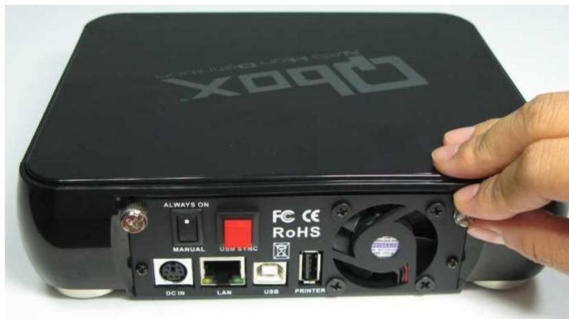
2. Démontez le capot. Vissez les rails de fixation sur votre Disque Dur à l'aide des 4 vis.
