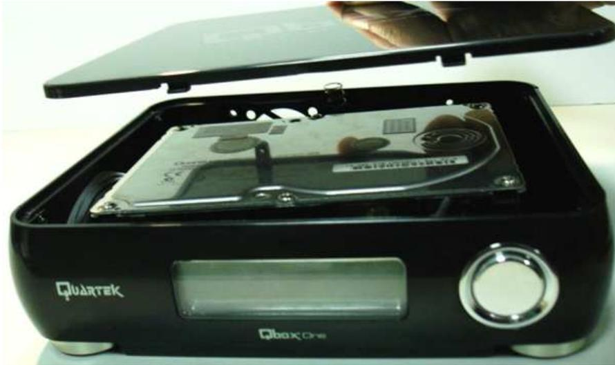
5. Refixez le capot à l'aide des 2 vis (molettes). Le disque est prêt à être configuré !
