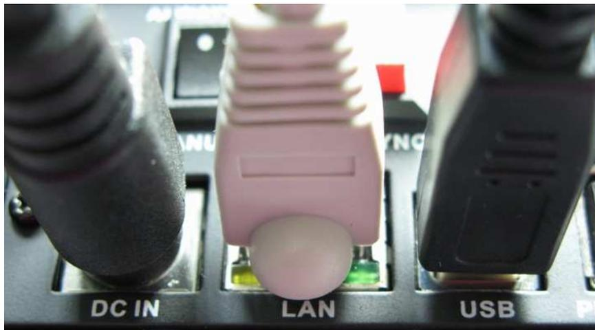
7. Connectez l'autre côté du câble Ethernet RJ-45 sur votre Hub/Routeur Ethernet ou Pc/Mac...Il est important qu'au démarrage de votre Qbox One, le Mode NAS ou le Mode Disque Dur USB2 soit automatiquement détecté, en identifiant s'il y a une activité réseau et sur la connexion RJ-45.
