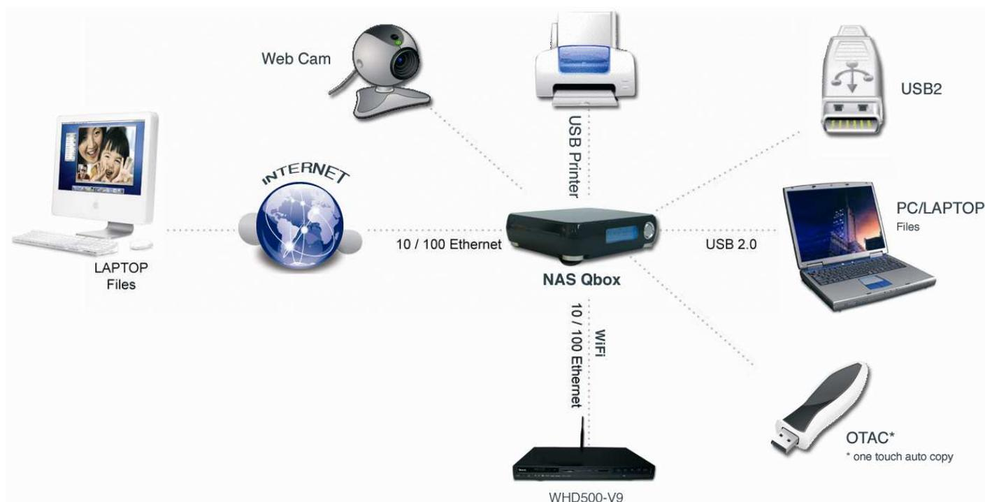
Votre Qbox One est un 'NAS' (Network Attached Storage), il s'agit d'un Boîtier Disque Dur servant de Stockage Réseau, connecté par un câble Ethernet RJ-45.
